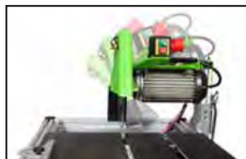
Hauteur de coupe réglable et coupe à 45° pour le biseau (MK45).
